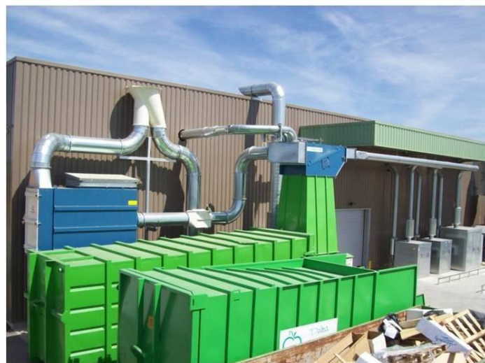
Aspiration de déchets de rognés de papiers et recyclage de l'air filtré. Installation conforme à la directive ATEX
